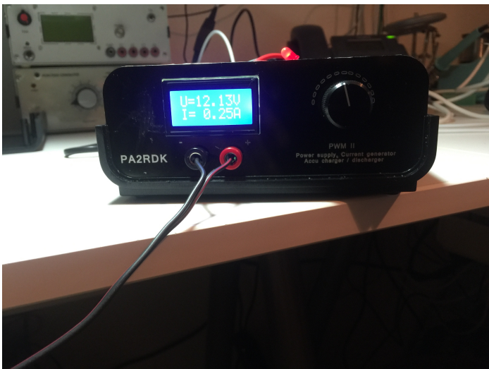
Boven: de PWM voeding gereed en werkend. Rechts: het display voor de montage.
